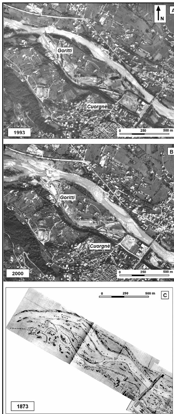
Fig. 4 - Località Goritti di Cuorgnè, deflusso verso destra. Le frecce sottolineano il percorso seguito dalla corrente di piena nel 1993 (A) e nel 2000 (B) lungo un antico ramo di deflusso precluso a fine '800 per derivazioni a scopo industriale (C).
